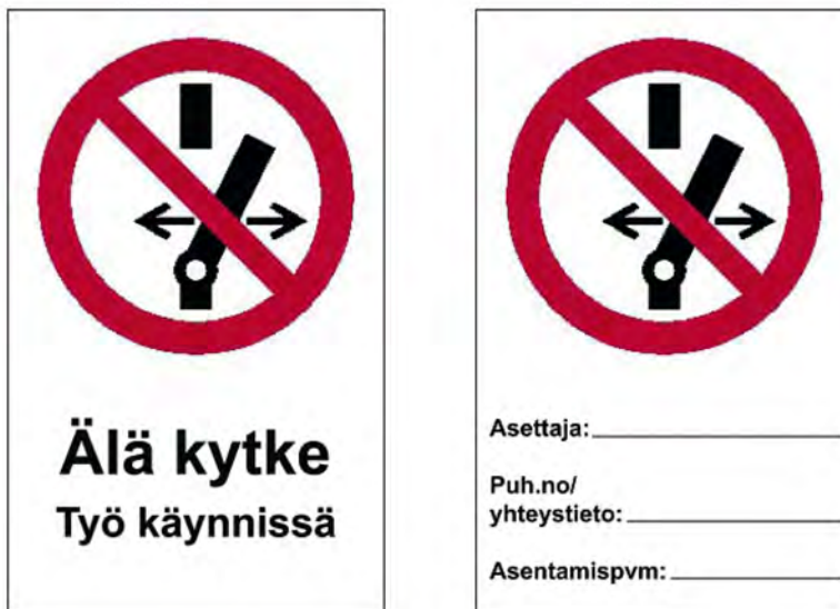
Kaksipuolinen kieltokilpi, jota käytetään varoittamaan käynnissä olevasta työstä ja kieltämään kytkimen asennon muuttamisen työn aikana
